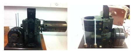
Figure2. Galvanometer Unit.
